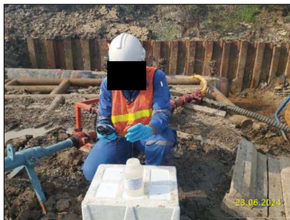
ก) เก็บตัวอย่างน้ำทั้งจากการทดสอบท่อด้วยวิธีทางชลสถิต (Hydrostatic Test)
