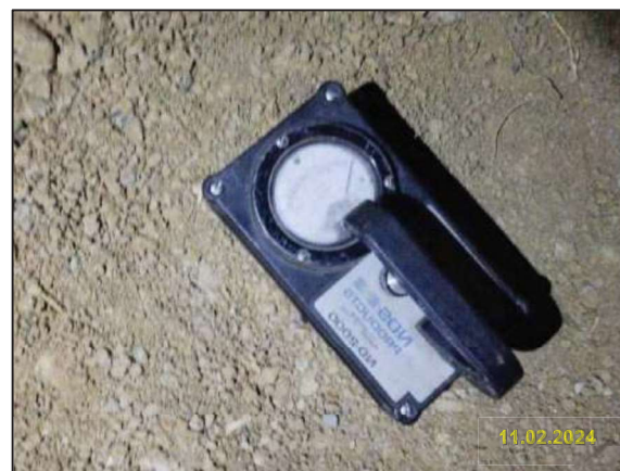
ค) วัดค่าปริมาณรังสีในพื้นที่งานตรวจสอบรอยเชื่อม
