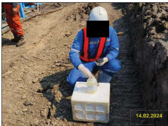
ก) เก็บตัวอย่างน้ำทั้งจากการทดสอบท่อด้วยวิธีทางชลสถิต (Hydrostatic Test)
