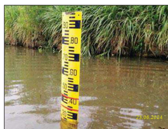
ข) ติดตั้งไม้วัดระดับน้ำ (Staff Gauge) บริเวณจุดสูบน้ำและระบายน้ำทิ้ง
