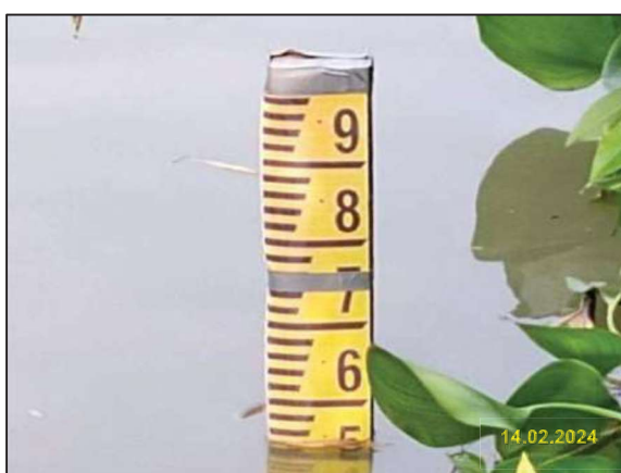
ข) ติดตั้งไม้วัดระดับน้ำ (Staff Gauge) บริเวณจุดสูบน้ำและระบายน้ำทิ้ง
